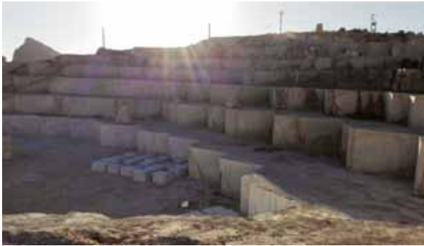
شکل ۳- روش مزرسی در استخراج بلوک در معدن گشایش بوانات
