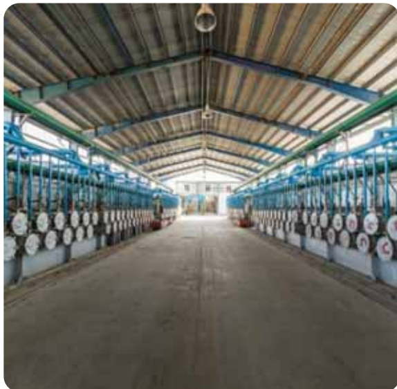
شکل ۱۰- نمایی از سالن احیا و همچنین مشعل‌های کوره حرارتی
