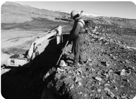
شکل ۸- نحوه لق‌گیری دیواره باطله برداری با بیل مکانیکی و نیروی انسانی در معدن خاک نسوز سمیرم
