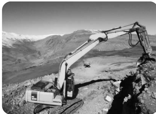
شکل ۸- نحوه لق‌گیری دیواره باطله برداری با بیل مکانیکی و نیروی انسانی در معدن خاک نسوز سمیرم
