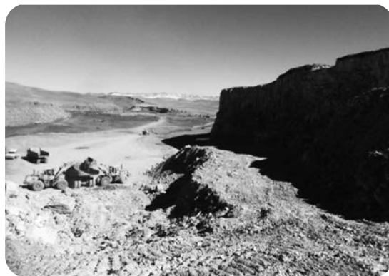
شکل ۱- نمایی از معدن و نحوه باطله برداری لایه آهکی در معدن خاک نسوز سمیرم
