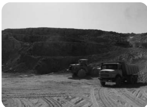
شکل ۷- روش باطله‌برداری پلکانی برای پیشگیری از ریزش دیواره در معدن خاک نسوز سمیرم
