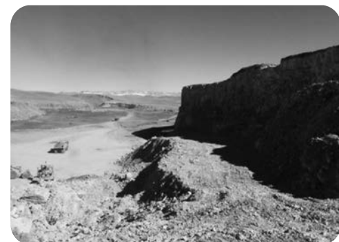
شکل ۷- روش باطله‌برداری پلکانی برای پیشگیری از ریزش دیواره در معدن خاک نسوز سمیرم
