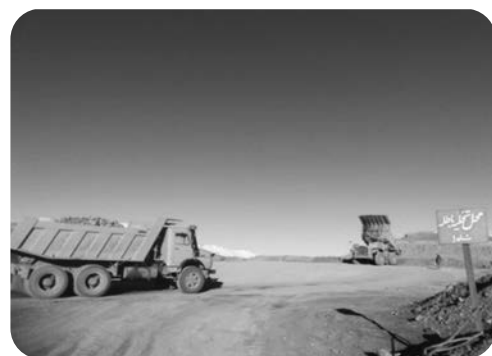
شکل ۶- مسیر تردد برای تخلیه باطله و آب‌پاشی جاده با تانکر در معدن خاک نسوز سمیرم
