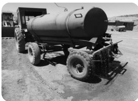
شکل ۶- مسیر تردد برای تخلیه باطله و آب‌پاشی جاده با تانکر در معدن خاک نسوز سمیرم
