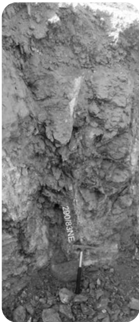
شکل ۱۲- نمای بخشی از گسل‌های فرعی موجود در منطقه معدن اصلی (در تصویر سمت راست چکش زمین شناسی بر روی سطح گسلی قرار دارد و در تصویر سمت چپ حضور گسل و پرشدگی آن توسط مالاکیت در کارهای قدیمی مشاهده می‌شود).
