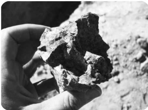
شکل ۱۷- نمایی نزدیک از کانی‌سازی آزریت در میزبان متادایبازی (تصویر سمت راست)، نمونه دستی از بخش کانی‌سازی زون اصلی و حضور کانی آزریت، مالاکیت و کالکوپیریت
