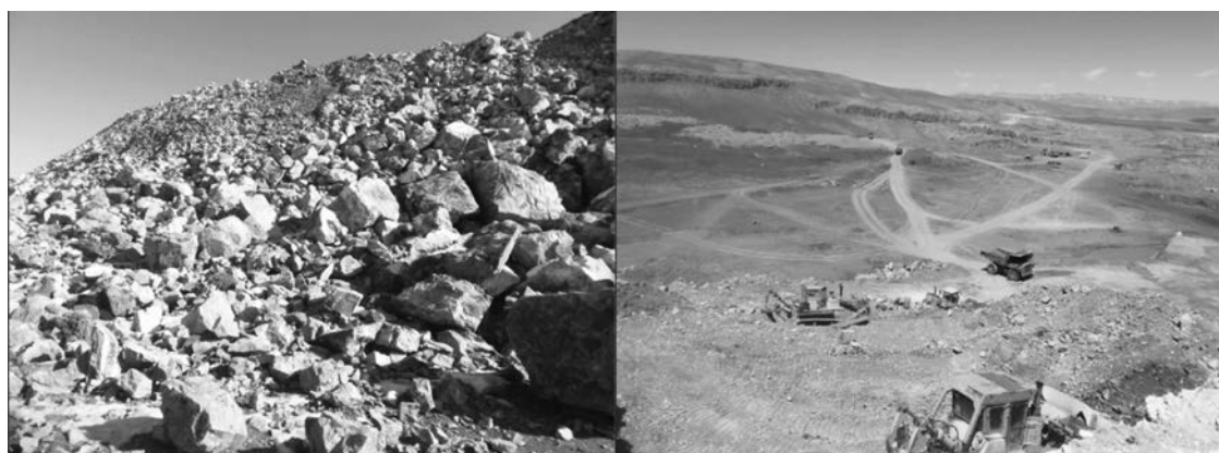
شکل ۱- باطله‌برداری لایه آهکی: سنگ‌های حاصل از انفجار در معدن خاک نسوز سمیرم
