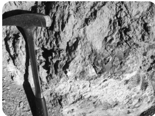
شکل ۱۷- نمایی نزدیک از کانی‌سازی آزریت در میزبان متادایبازی (تصویر سمت راست)، نمونه دستی از بخش کانی‌سازی زون اصلی و حضور کانی آزریت، مالاکیت و کالکوپیریت
