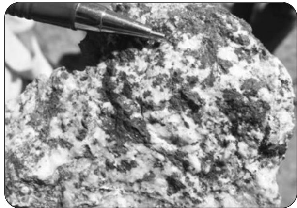
شکل ۳- نمایی از حضور رگچه‌های سیلیسی در واحد متادیابازی همراه با کانی‌سازی مس به صورت مالاکیت و آزوریت
