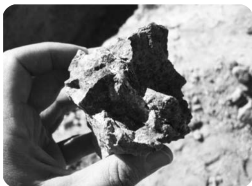
شکل ۱۷- نمایی نزدیک از کانی‌سازی آزوریت در میزبان متادیابازی (تصویر سمت راست)، نمونه‌دستی از بخش کانی‌سازی زون اصلی و حضور کانی آزوریت، مالاکیت و کالکوپیریت
