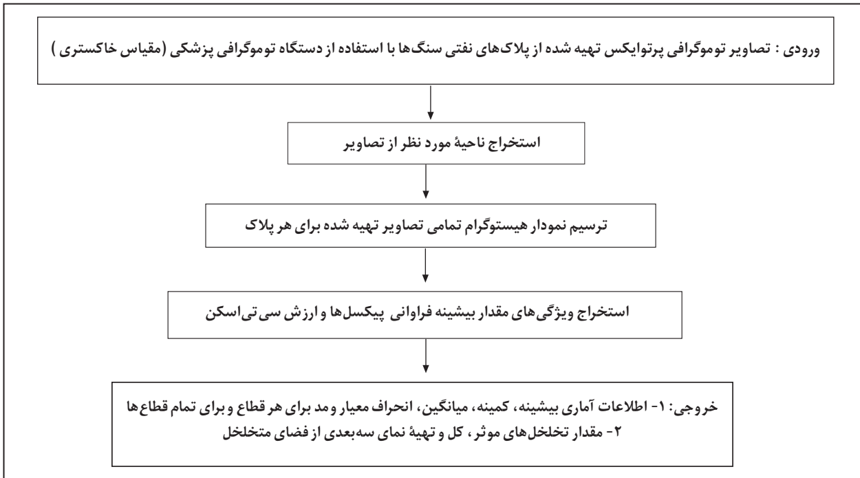
شکل ۴- فلوچارت الگوریتم پیشنهادی به منظور استخراج اطلاعات آماری و تعیین مقدار تخلخل پلاک های مورد بررسی را با استفاده از تصاویر توموگرافی پرتو ایکس
